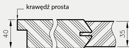
Przekrój poziomy drzwi Elsa
